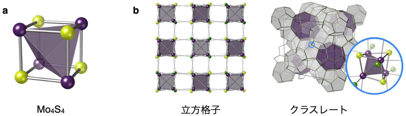
図1 (a) 立方体型の超原子 $\text{Mo}_4\text{S}_4$ クラスターと (b) 先行研究で報告されていた三次元集積体のモデル図。
