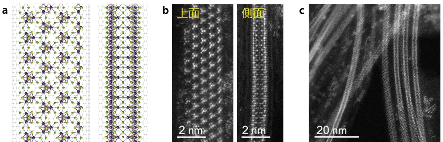
図3 (a) カーボンナノチューブの内部空間に成長した $\text{Mo}_8\text{S}_8\text{Cl}_{11}$ ナノリボンのモデル図および (b, c) 透過電子顕微鏡写真。モデル図と同様の構造が安定して存在している。
