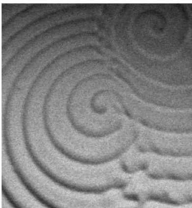
氷結晶の成長中に水-氷界面に現れるらせんパターン（左）とその概略図（右）。
