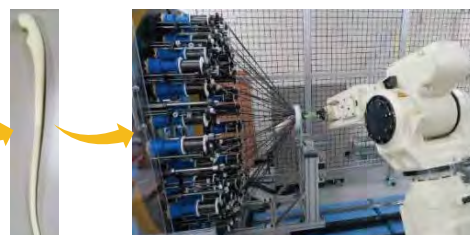
組紐+ロボットによる一体成形
