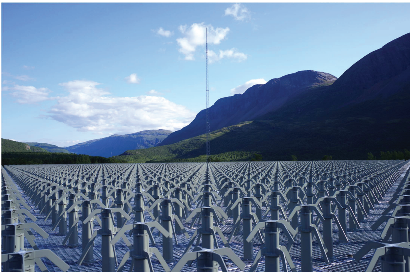
図 3: 最先端の大型大気レーダー「EISCAT_3D」。約 1 万本のアンテナが並び、超高層大気の 3 次元観測を実現する。(国立極地研究所 伊藤ゆり撮影)
