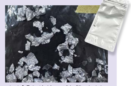
レトルト食品のパウチも、アルミとプラスチックのマルチマテリアル成形品。このままでは焼却もリサイクルもできないため、アルミを取り出す実験中。
