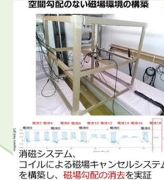
消磁システム、コイルによる磁場キャンセルシステムを構築し、磁場勾配の消去を実証
