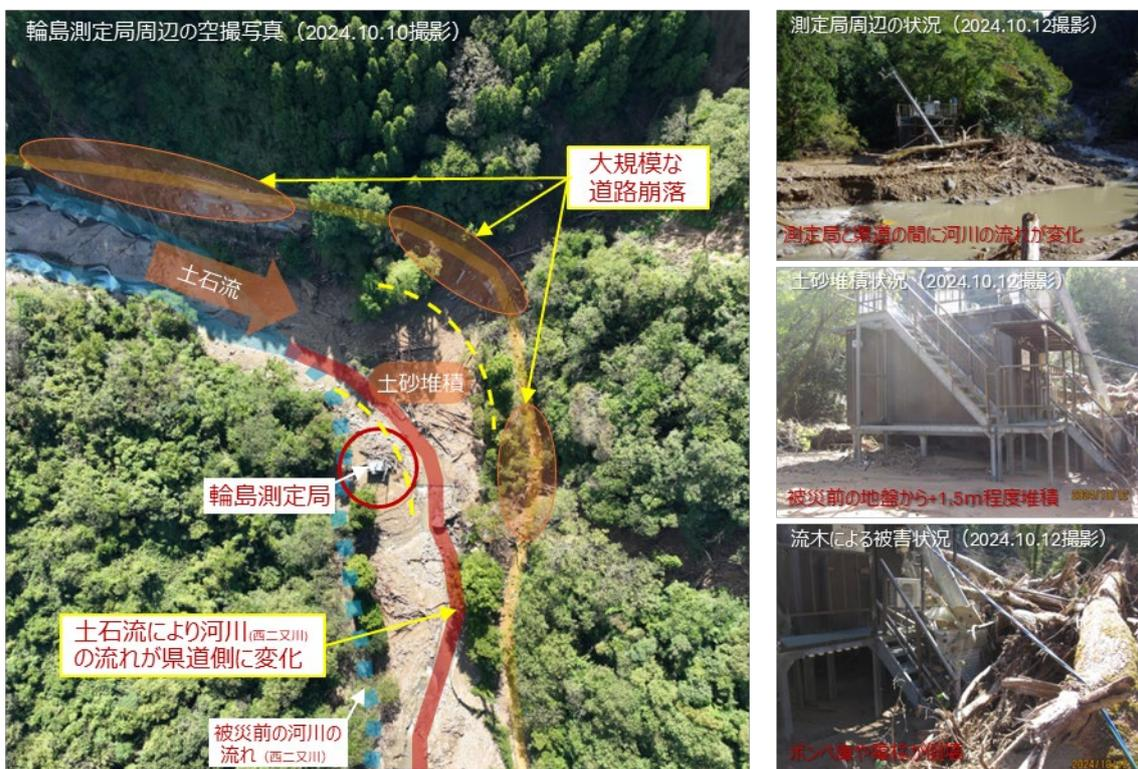
図 2-6-6：被害状況（上：被災前の外観と測定装置、下：被災後の空撮、土砂や流木の堆積状況等）
